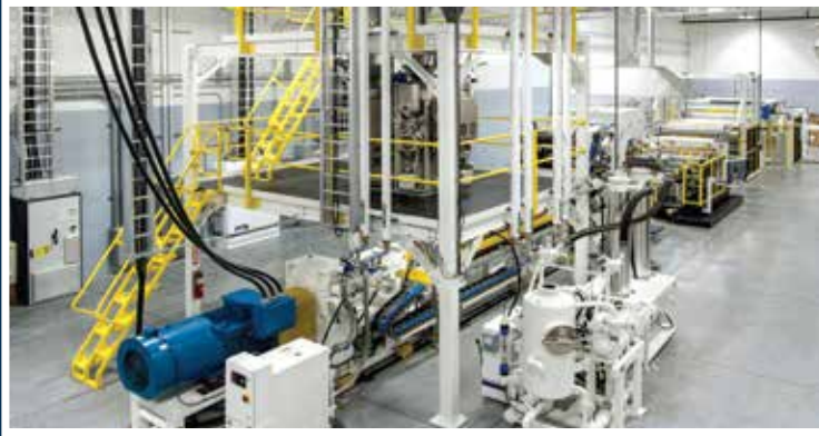
TDC LÍNEA 1: MODELO HVTSE® 85 mm-52D DryerLESS™ EXTRUSIÓN DE LÁMINA DE RESINA MÚLTIPLE A TRAVÉS DE LA BOBINADORA PARA VELOCIDADES DE HASTA 2200 PPH (1000 KG/HR).
