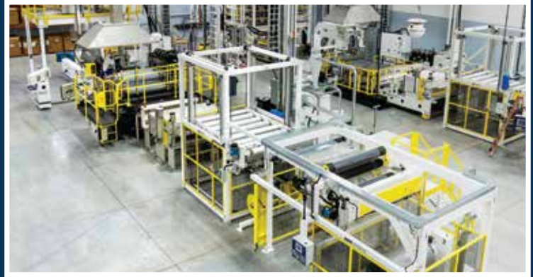
TDC LÍNEA 2: SUPER-G® HighSPEED™ MODELO SGHS3000-36D EXTRUSIÓN DE HOJAS A TRAVÉS DE LA BOBINADORA PARA VELOCIDADES DE HASTA 3000 PPH (1350 KG/HR).
