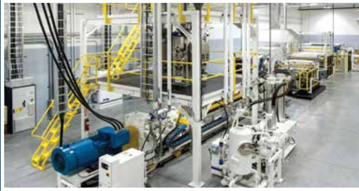
TDC LÍNEA 1: MODELO HVTSE® 85 mm-52D DryerLESS™ EXTRUSIÓN DE LÁMINA DE RESINA MÚLTIPLE A TRÁVÉS DE LA BOBINADORA PARA VELOCIDADES DE HASTA 2200 PPH (1000 KG/HR).
