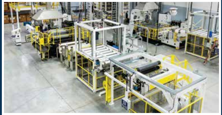
TDC LÍNEA 2: SUPER-G® HighSPEED™ MODELO SGHS3000-36D EXTRUSIÓN DE HOJAS A TRÁVÉS DE LA BOBINADORA PARA VELOCIDADES DE HASTA 3000 PPH (1350 KG/HR).
