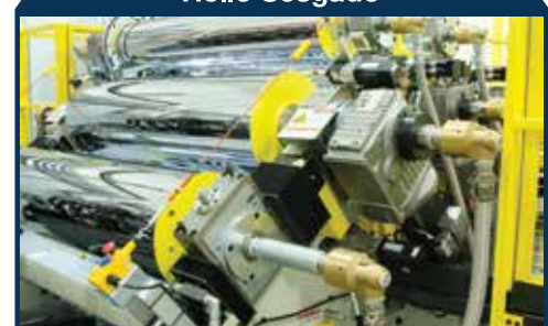
Sesgo de rollo para procesamiento de calibre delgado (pat. pend.)
