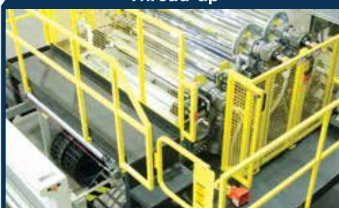
Dispositivo mecánico para facilitar el enhebrado
